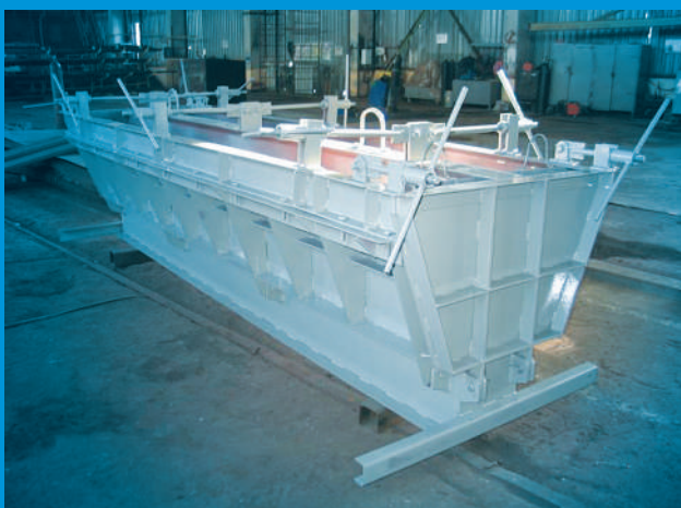
Опалубка карнизных блоков "Мостотряд-81" - строительство моста через реку
